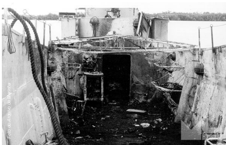
Em cima, consequências de um incêndio na LDM 312 e, em baixo, o “poço” da LDM 309 atingida pelo rebentamento de um engenho explosivo aquático (EEA) accionado a partir da margem no rio Armada, afluente do Cacheu
